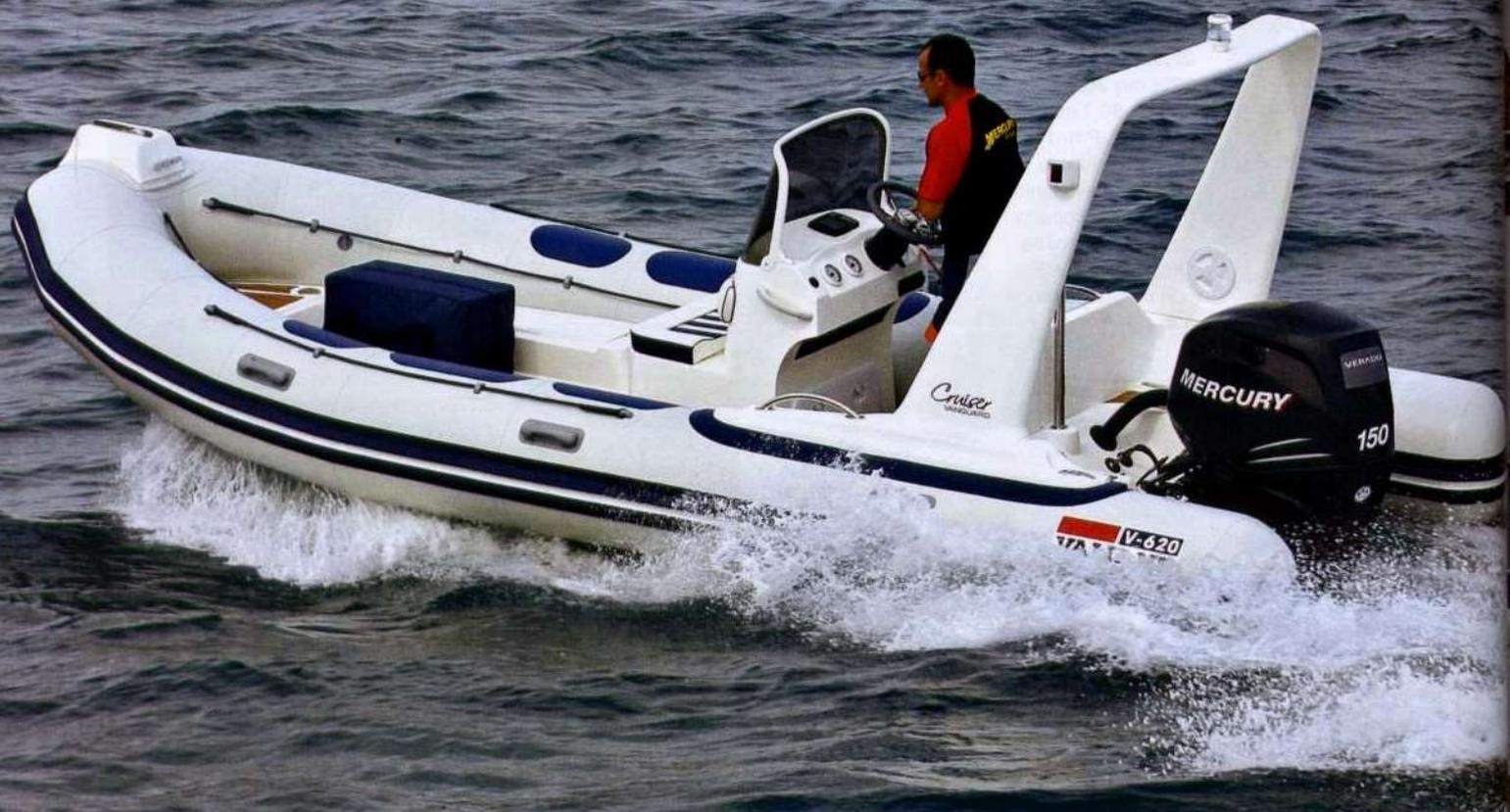
Un package interessante: il nuovo Verado 150 cv, quattro tempi quattro cilindri con sovralimentazione e un battello robusto.
